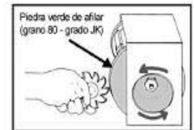
Posición para afilar la fresa
